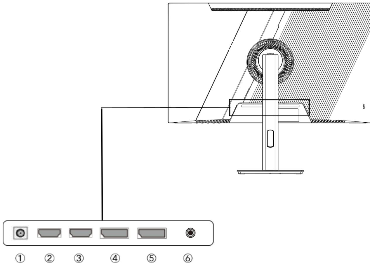
**1: Fuente de alimentación:** Se utiliza al conectar el cable de alimentación.
