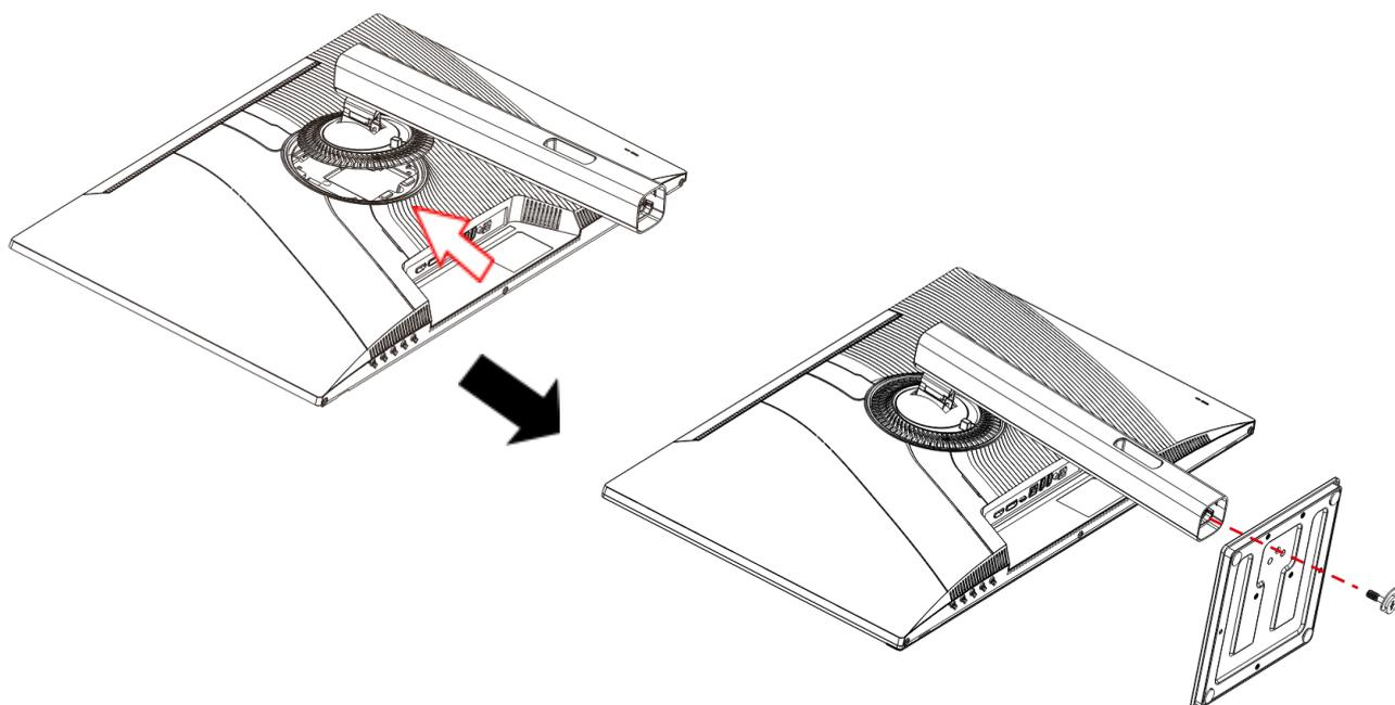
4. Asegúrese de que el monitor y el soporte estén bien sujetos y luego levante lentamente el monitor.
